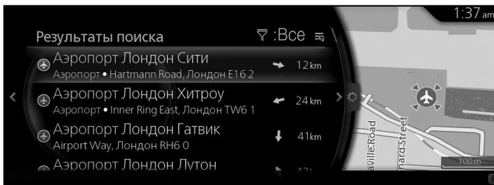
3. Отклоните вправо центральную рукоятку многофункционального переключателя «Commander» и выведите на дисплей панель опций, чтобы изменить порядок отображения пунктов списка с помощью опции «Сортировать по» (Sort By) и ограничить область поиска с помощью опции «Область поиска» (Search Area).
